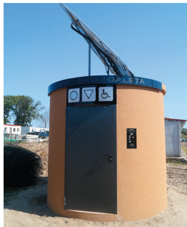
Toaleta z kolektorem słonecznym i modułem fotowoltaicznym
